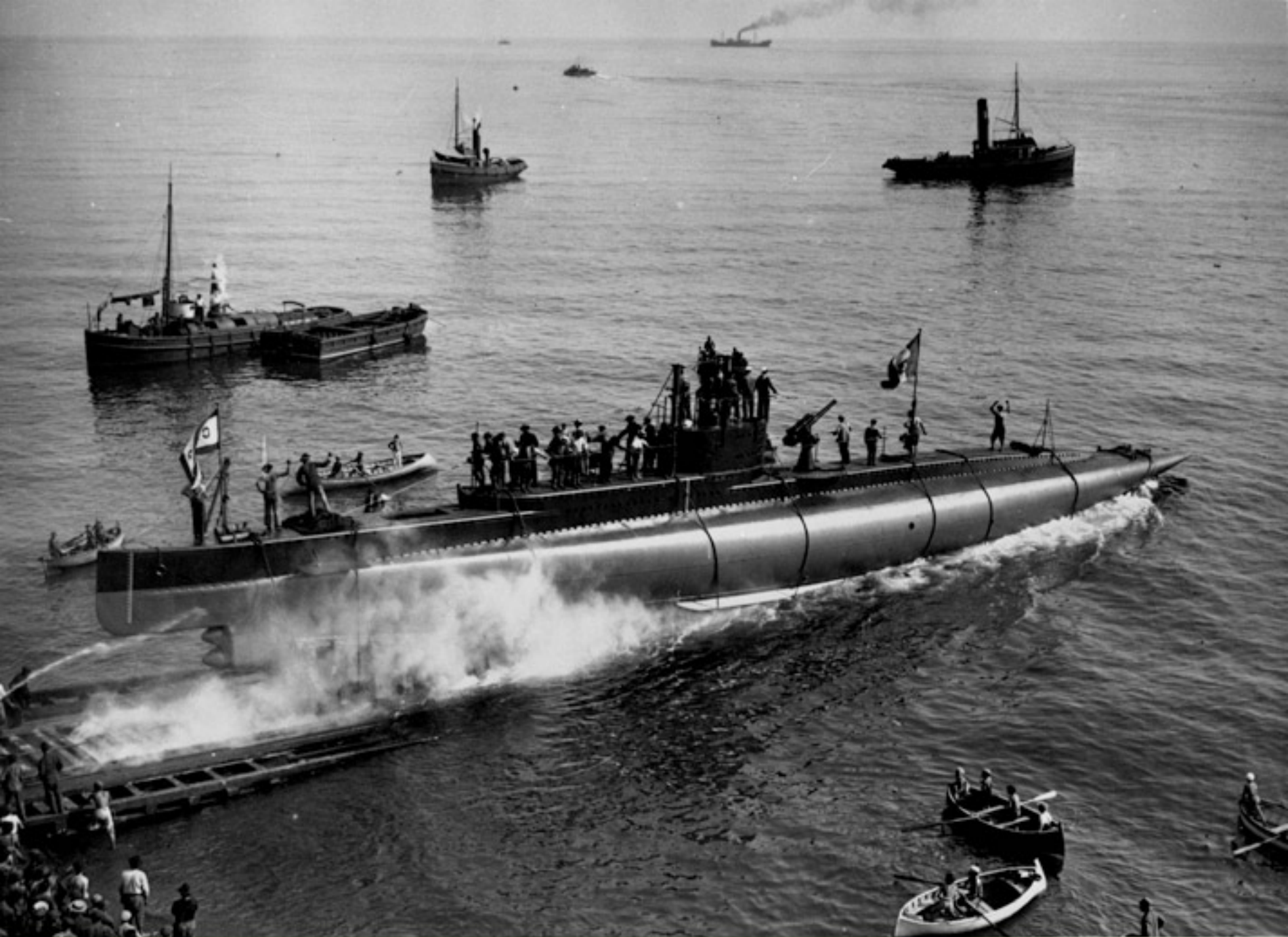
Varo del sommergibile classe N. Cantieri Navali Ansaldo di Sestri Ponente. Genova, 1918 Fondazione Ansaldo, Genova
